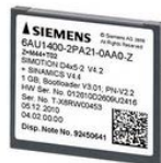
Carte flash 1GB avec le firmware et la licence d'utilisation MecaMotion
